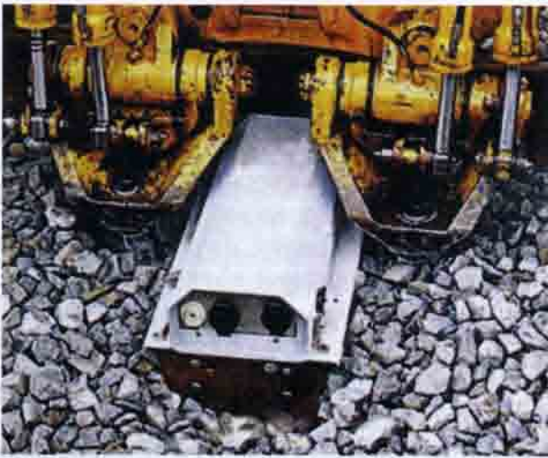
Рис. 11.12. Работа путевой машины на стрелочном переводе, оснащенной приводом, в полой шпале
