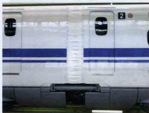
Рис. 3.17. Аэродинамическое эластичное перекрытие зазора между вагонами высокоскоростного поезда серии N700. Япония. 2007 г.
