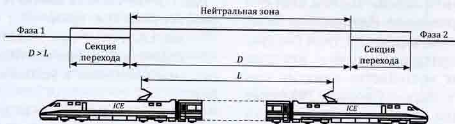
Рис. 10.38. Условие для определения длины зоны нейтральной вставки
