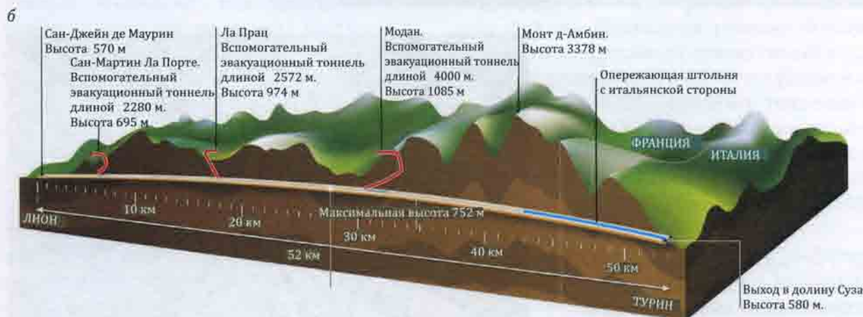
Рис. 8.29. Схема вспомогательного эвакуационного тоннеля Модан (а) и схема тоннеля Д'Амбин ВСМ Лион — Турин (б)
