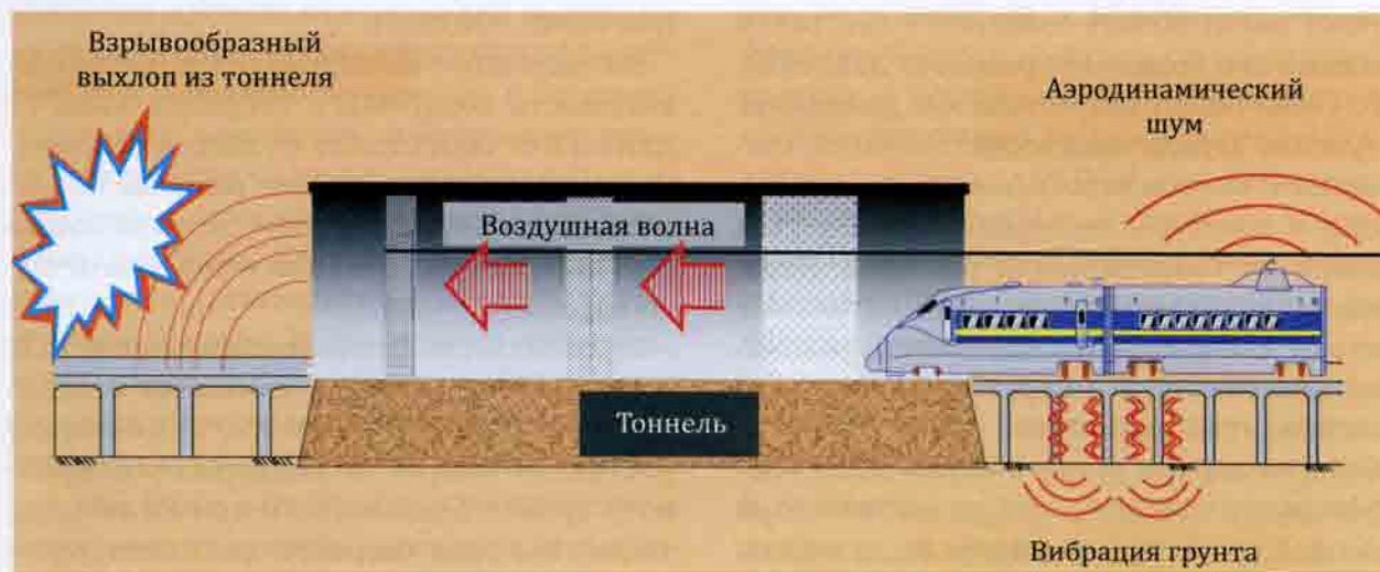
Рис. 8.34. Акустические и вибрационные явления при проходе высокоскоростного поезда в тоннеле
