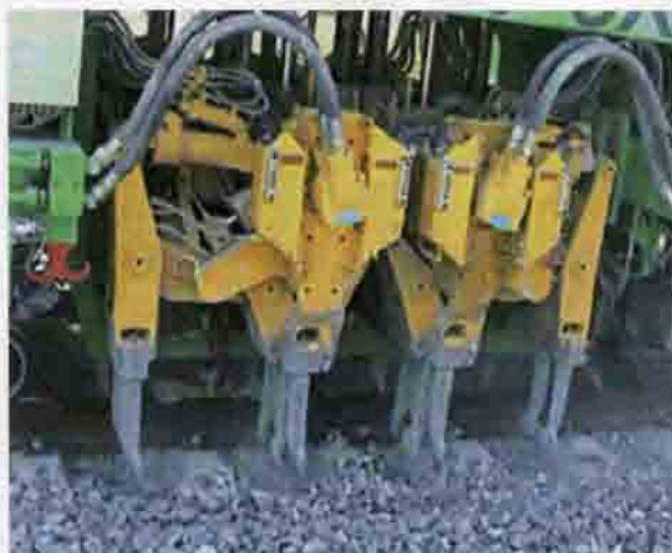
Рис. 6.22. Выправка и рихтовка пути при постановке его в проектное положение с подбивкой балласта: а — ход выправочно-бивочно-рихтовочной машины (ВПР); б — рабочие органы
