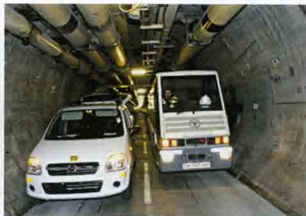
Рис. 8.38. Автомобили спасателей на автомобильной дороге вспомогательного транспортно-технологического тоннеля тоннельного пересечения под Ла-Маншем
