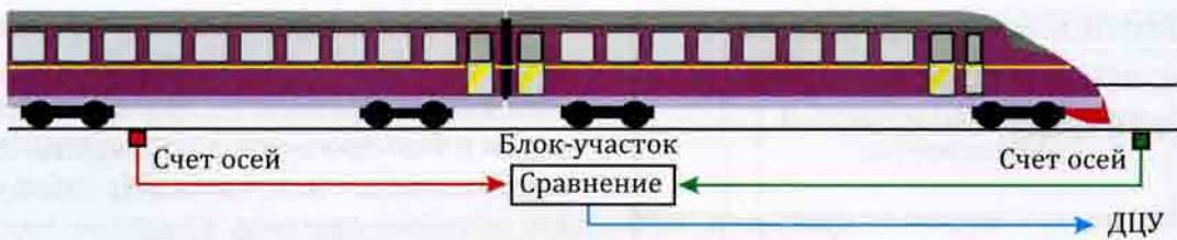
Рис. 11.5. Принцип определения занятости блок-участка с помощью счета осей на его входе и выходе
