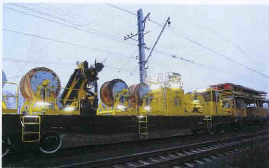
Рис. 10.49. Опытный раскаточный поезд с системой автоматического задания величины натяжения проводов контактной подвески. Италия — Россия. 2012 г.
