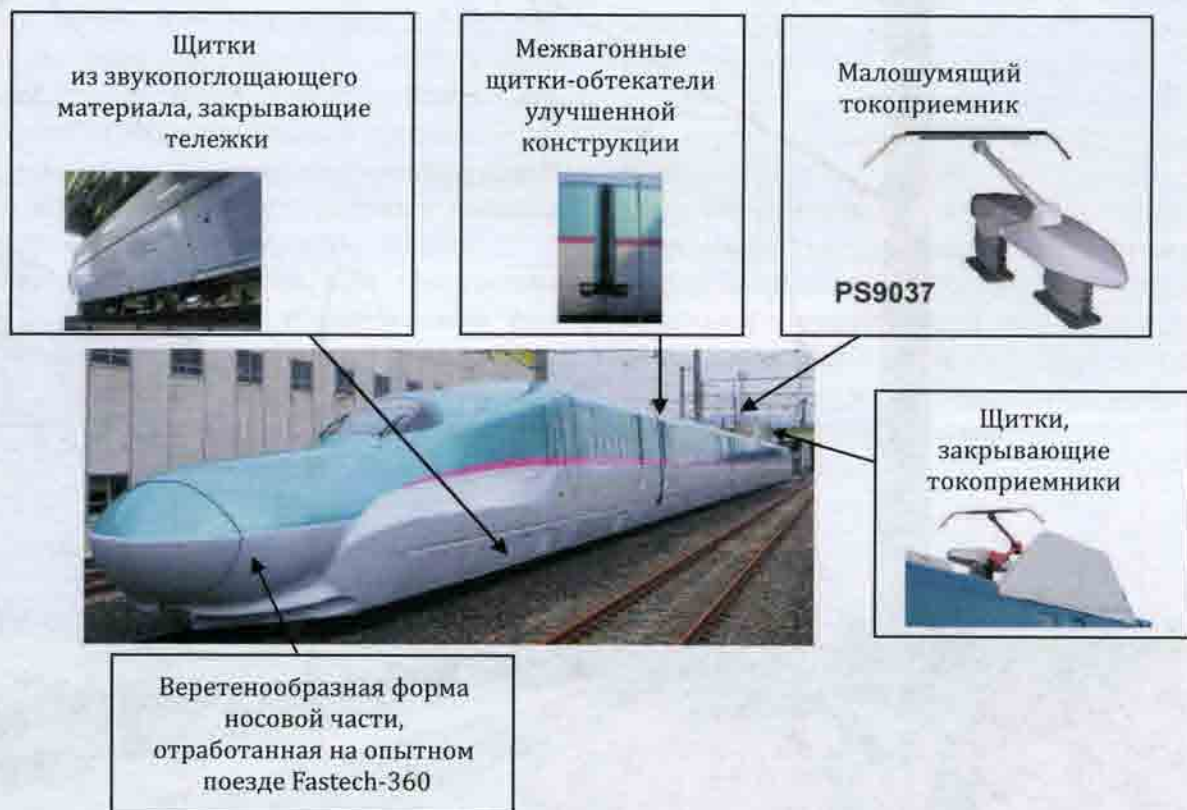
Рис. 3.16. Элементы конструкции поезда серии E5 для снижения шума. Япония. 2011 г.
