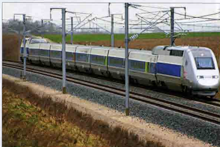
Рис. 10.29. Контактная сеть однофазного переменного тока 2 \times 25 кВ, 50 Гц: а — двухпутный участок с несущими конструкциями с жесткой поперечной; б — зона сопряжения анкерных участков. 2005 г.
