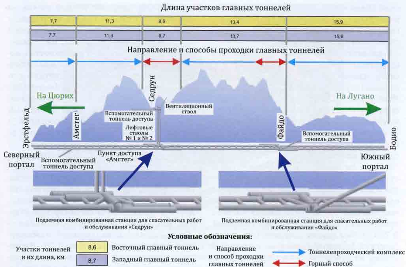
Рис. 8.26. Схематическое изображение Готтардского базисного тоннеля
