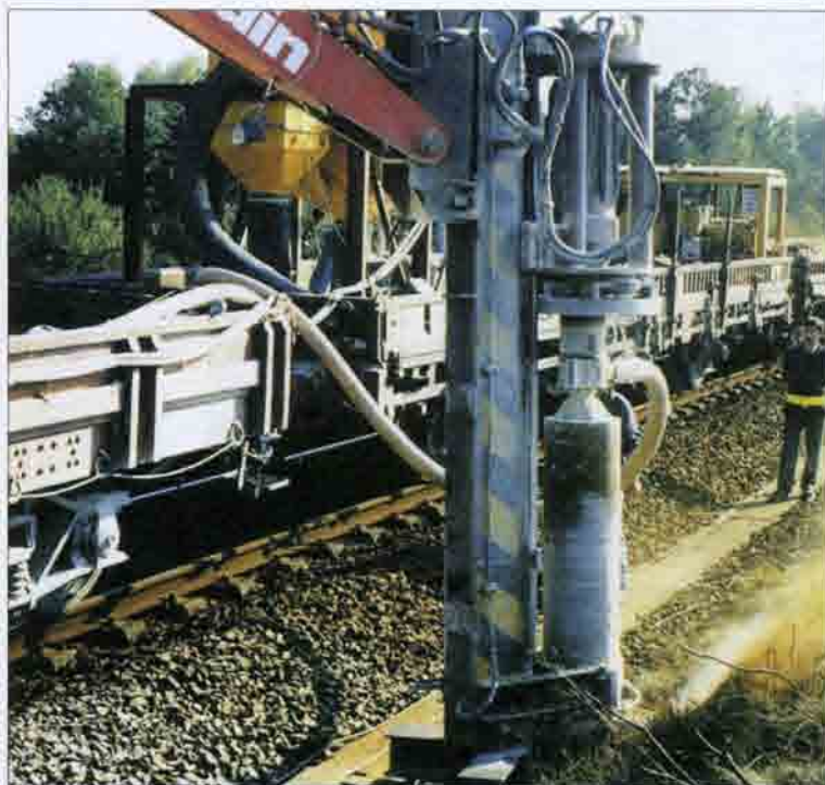
Рис. 10.45. Установка на железнодорожном ходу, применяемая для бурения скважин под фундаменты опор контактной сети и их бетонирования. Франция, 1995 г.
