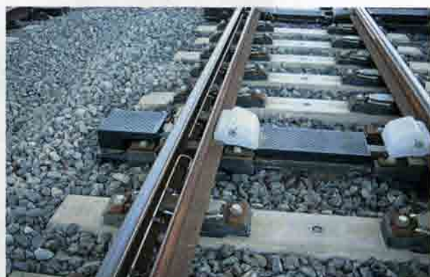
Рис. 6.56. Основные этапы укладки стрелочного перевода на ВСМ: а — раскладка переводных брусьев; б — монтаж элементов перевода с помощью крана; в — стрелочный перевод, подготовленный к монтажу переводного механизма и электроприводов; г — устройства электрообогрева стрелки
