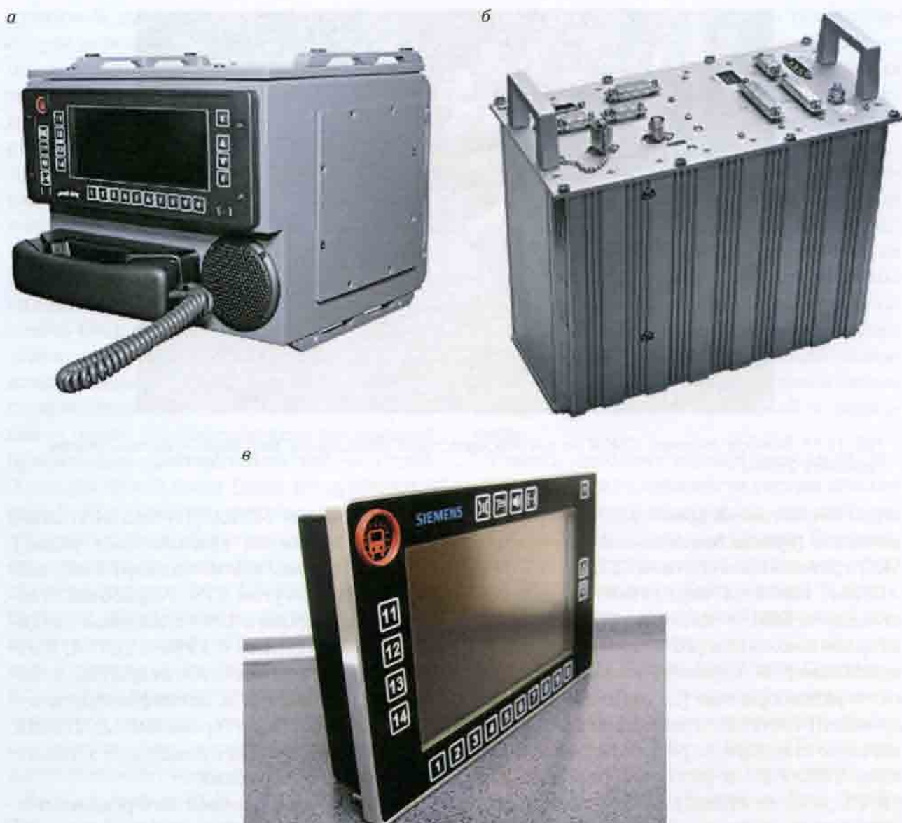
Рис. 11.20. Примеры аппаратуры системы GSM-R: а — портативное переговорное устройство для кабины машиниста; б — контейнер с приборами поездного комплекта GSM-R; в — графический дисплей приема и передачи данных GSM-R для кабины машиниста
