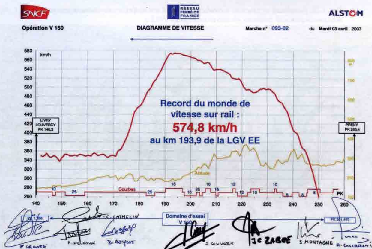
Рис. 1.21. Скоростная диаграмма рекордной поездки поезда V150 3 апреля 2007 г. В нижней части графика указаны километры линии, на которой проходили испытания (от 140 до 260), выше схематически изображен план: горизонтальными прямыми показаны прямые участки пути, вертикальными — кривые, еще выше (желтая линия) — продольный профиль пути. Поезд в опытной поездке двигался от 250-го км к 140-му км (на графике — справа налево). Набор скорости для выхода на рекордную величину был начат на 220-м км, рекорд скорости 574,8 км/ч был установлен в момент выхода со спуска в районе 193-го км. Внизу на графике — подписи руководителей испытания
