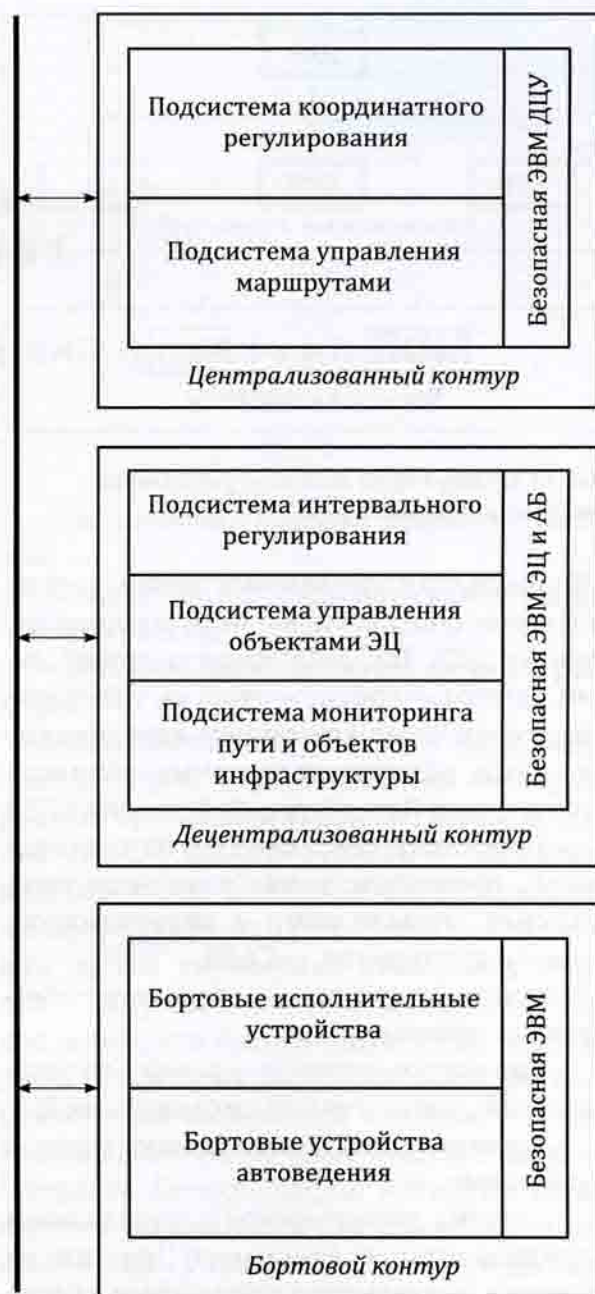
Рис. 11.2. Контурсы обеспечения безопасности движения поездов на ВСМ
