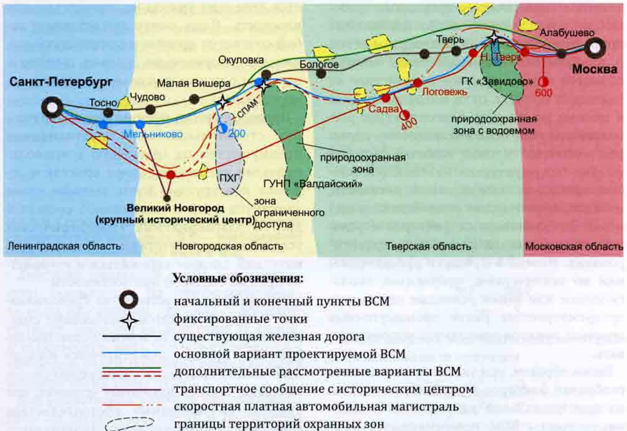
Рис. 5.2. Пример возможных вариантов направления ВСМ между заданными конечными пунктами Санкт-Петербургом и Москвой
