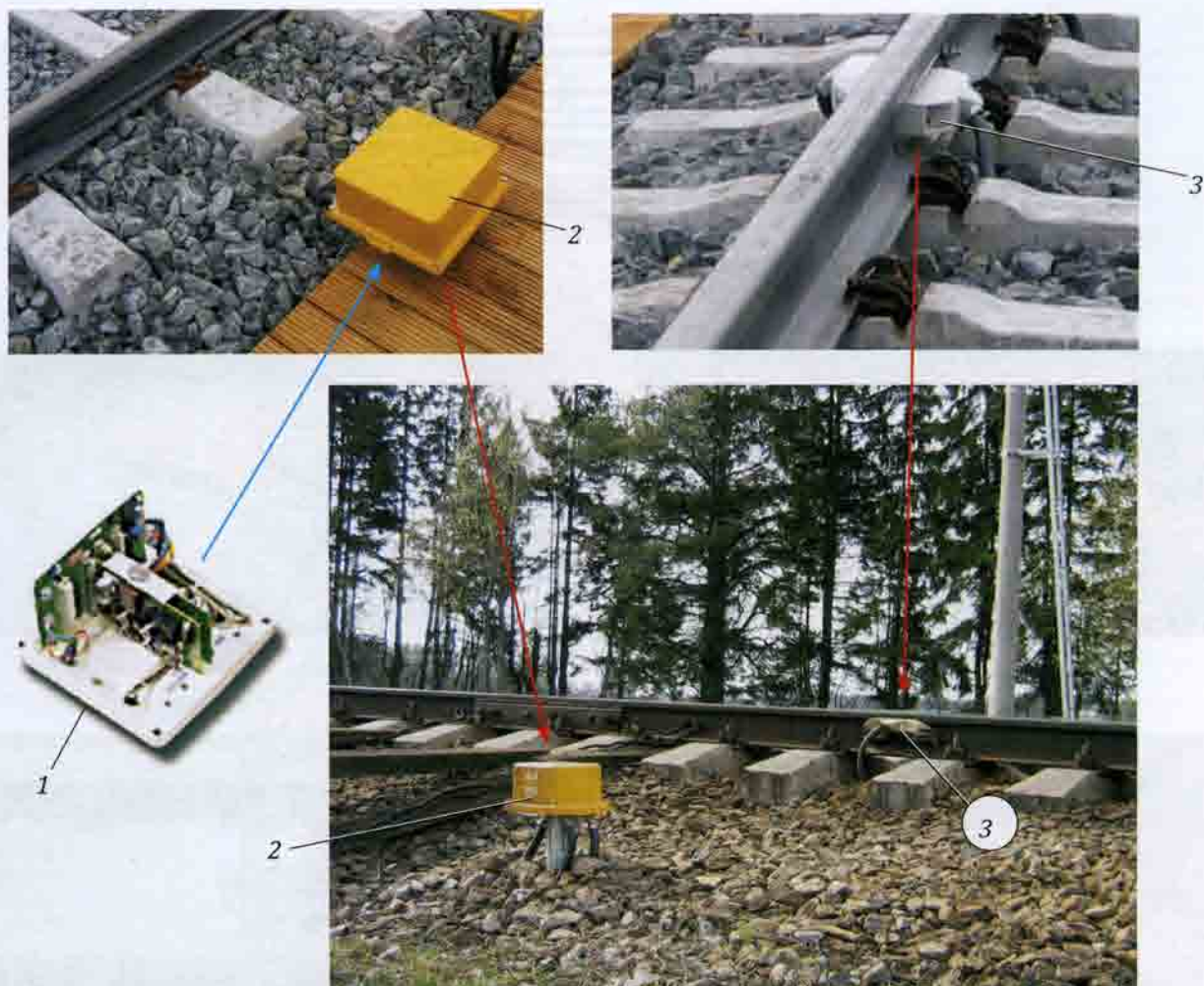
Рис. 11.6. Компоненты устройства электронной путевой педали фирмы «Сименс» и пример ее установки на пути: 1 — приборный блок (внутренний вид); 2 — размещение приборного блока на пути; 3 — индукционный датчик («педаль»)
