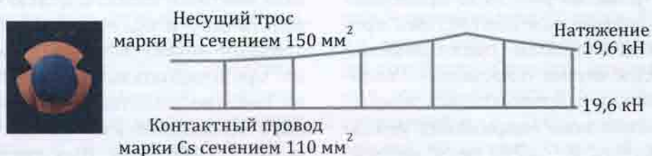
Рис. 10.16. Поперечный разрез стале-медного биметаллического контактного провода марки CS с площадью сечения 110 \text{ мм}^2 японских высокоскоростных железных дорог и схематическое изображение контактной подвески
