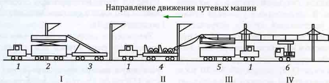
Рис. 10.44. Основные работы, входящие в комплекс электрификации: I — монтаж опор; II — раскатка проводов; III — временное крепление проводов; IV — окончательное крепление проводов с соблюдением проектных отметок по высоте и в плане. Основные машины, используемые при электрификации: 1 — мотовоз; 2 — платформа с буровым станком и краном для установки опор; 3 — платформа со столбами для опор контактной сети; 4 — раскаточный комплекс; 5 — подъемная площадка для первичного крепления проводов; 6 — самодвижущаяся подъемная площадка для окончательного крепления проводов
