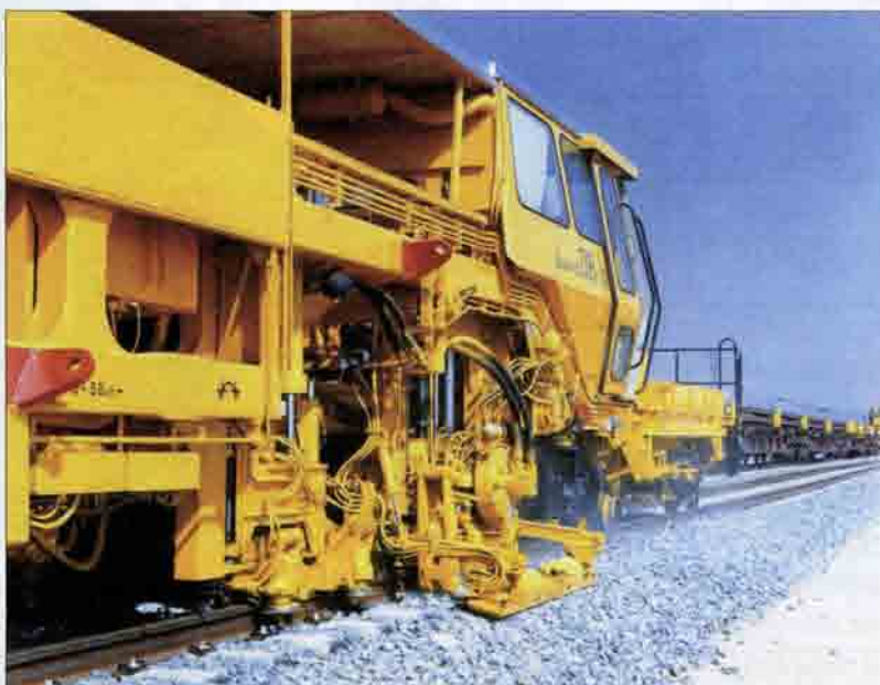
Рис. 6.20. Механизированное закрепление рельсов на шпалах
