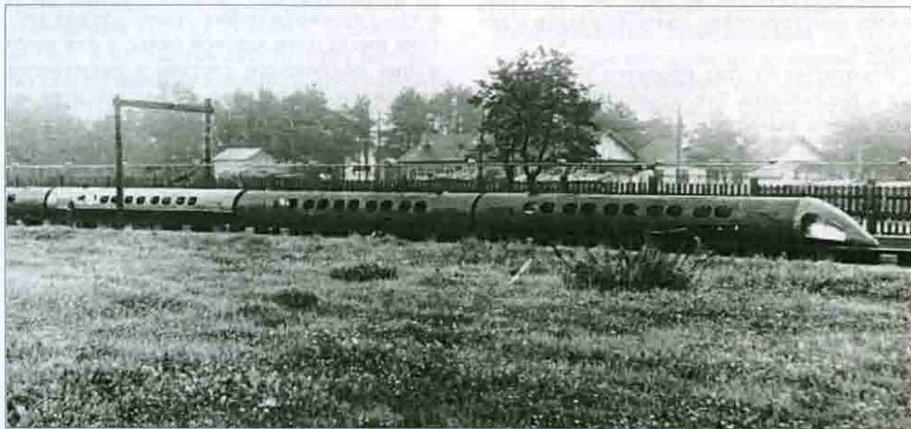
Рис. 2.4. Высокоскоростная шароэлектрорельсовая транспортная система Н.Г.Ярмольчука. Поезд на пути «шародрома» вблизи Москвы СССР. 1933 г.
