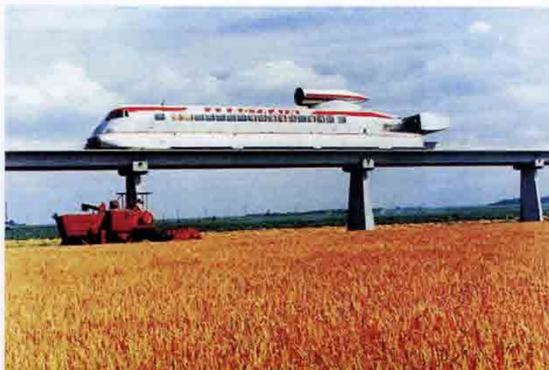
Рис. 2.9. Аэровагон L'Aerotrain 180 HV на опытной дороге вблизи Бордо. Франция. 70-е годы XX в.
