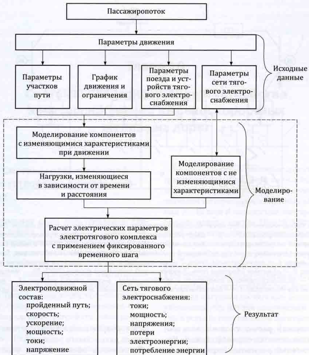
Рис. 10.2. Алгоритм расчета электротягового комплекса методом математического моделирования
