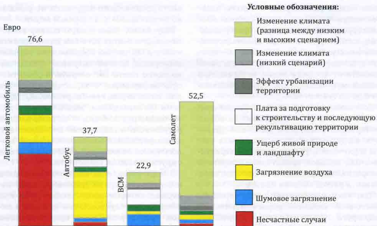
Рис. 3.4. Усредненные дополнительные издержки (евро) при пассажирских перевозках различными видами транспорта в пересчете на 1000 пасс.-км
