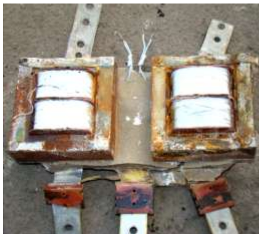
Рис. 8. Состояние обмоток дроссель-трансформатора при нарушенной герметизации корпуса
