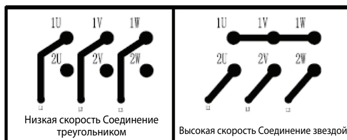
Рисунок 2-1 – СХЕМА ПОДКЛЮЧЕНИЯ ЭЛЕКТРОДВИГАТЕЛЯ
