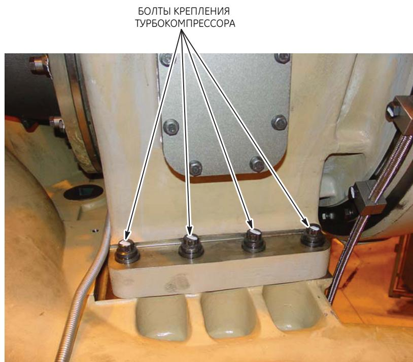
Рис. 111. Болты крепления турбокомпрессора 7S1712
