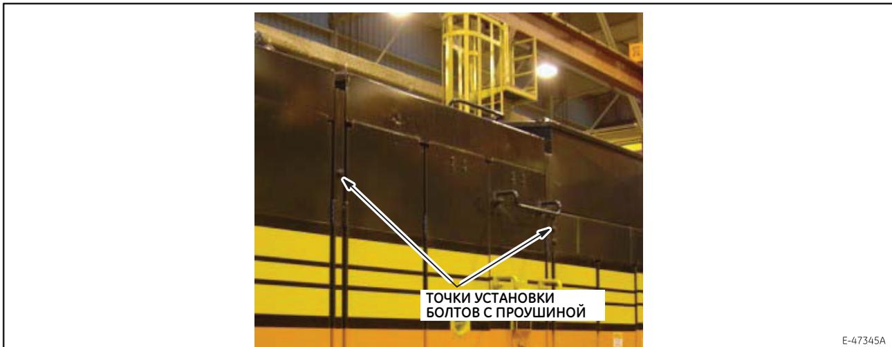
Рис. 83. Точки установки рым-болтов на отсек двигателя (типичные).
