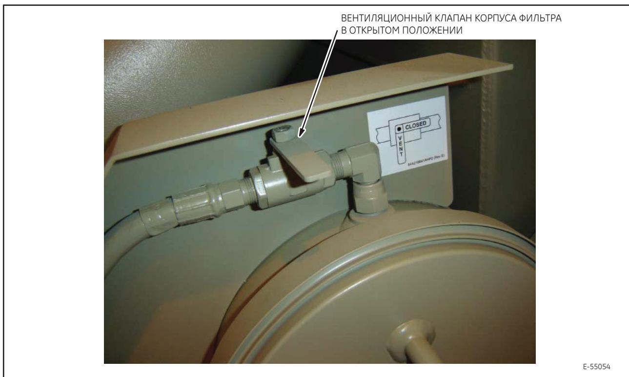
Рис. 44. Вентиляционный клапан топливного фильтра
