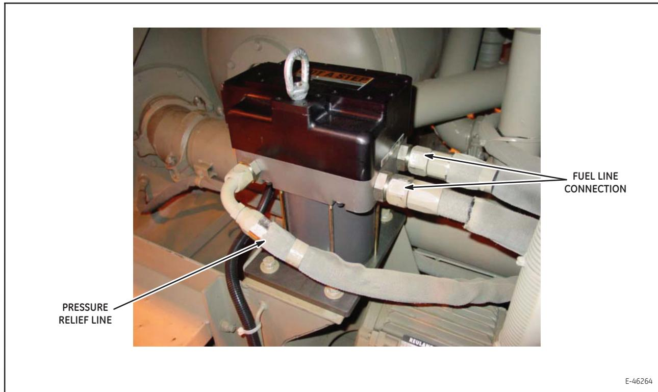
Рис. 36. Топливные соединения топливоперекачивающего насоса
