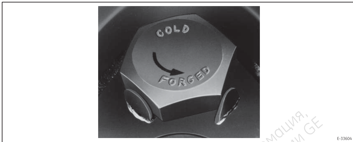
Figure 10. Прижмите лепесток блокирующей пластины к головке винта так, чтобы он препятствовал ослаблению винта.
