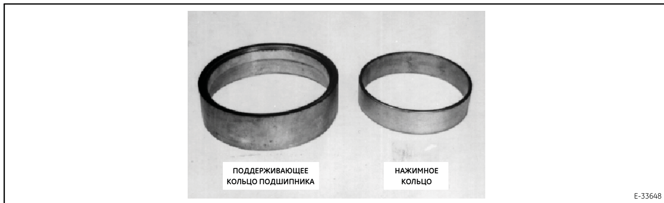
Figure 55. Комплект приспособлений для установки уплотнений.
