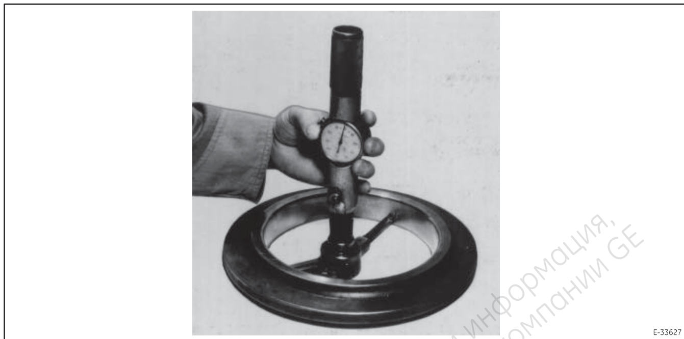
Figure 33. Эталонное кольцо для проверки микрометра (Ring Master).
