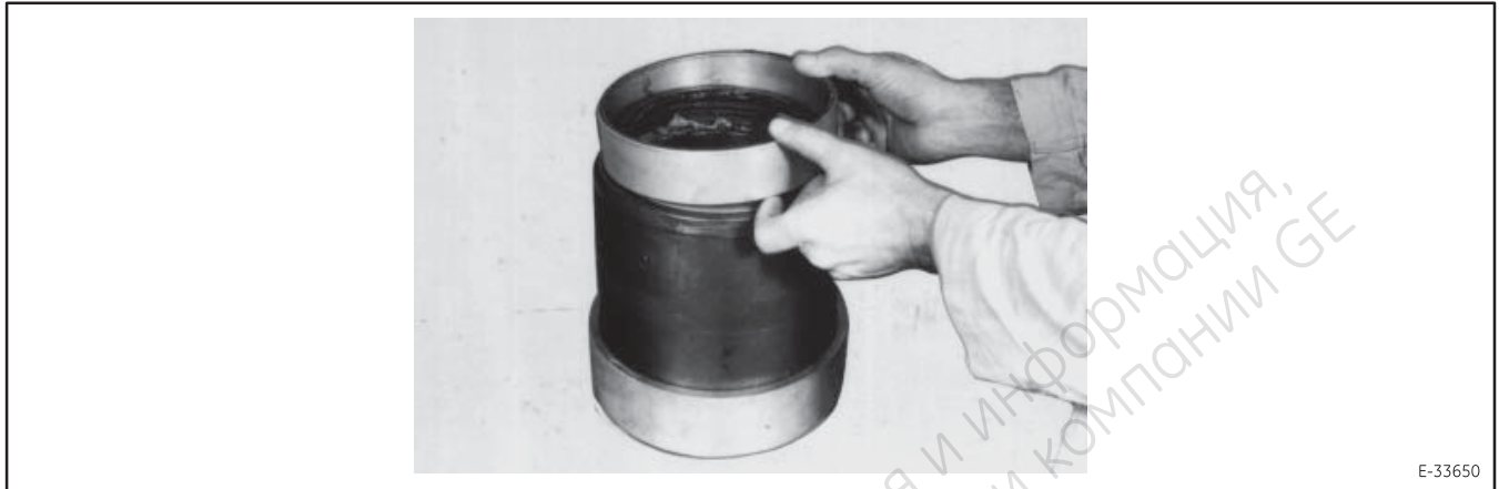
Figure 57. Установка нажимного кольца на уплотнение.
