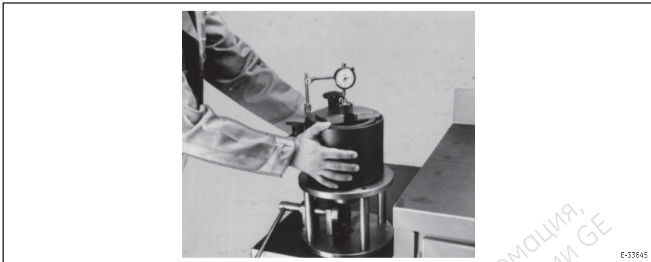
Figure 52. Активация кулачкового механизма и снятие показаний циферблатного индикатора.
