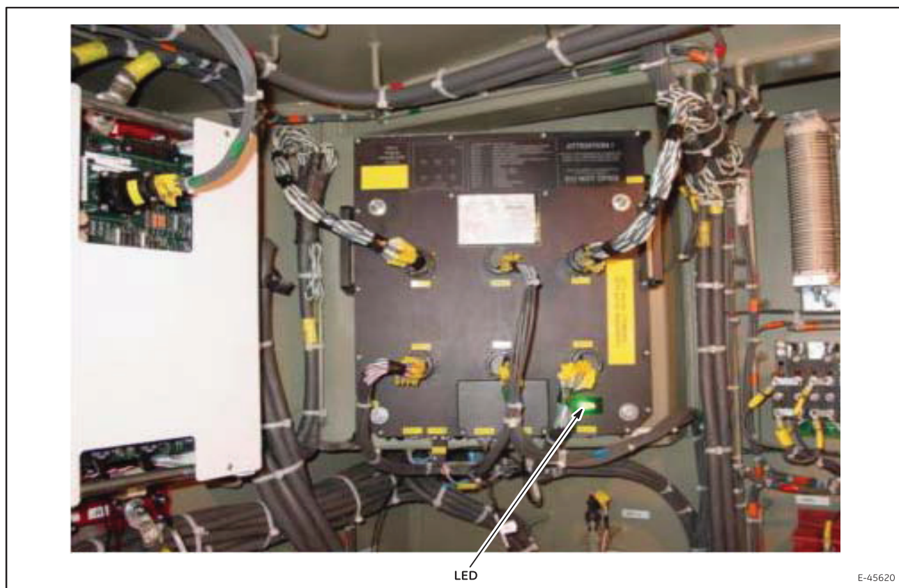
Рис. 5. Блок управления двигателем с разъемами во вспомогательном отсеке.
