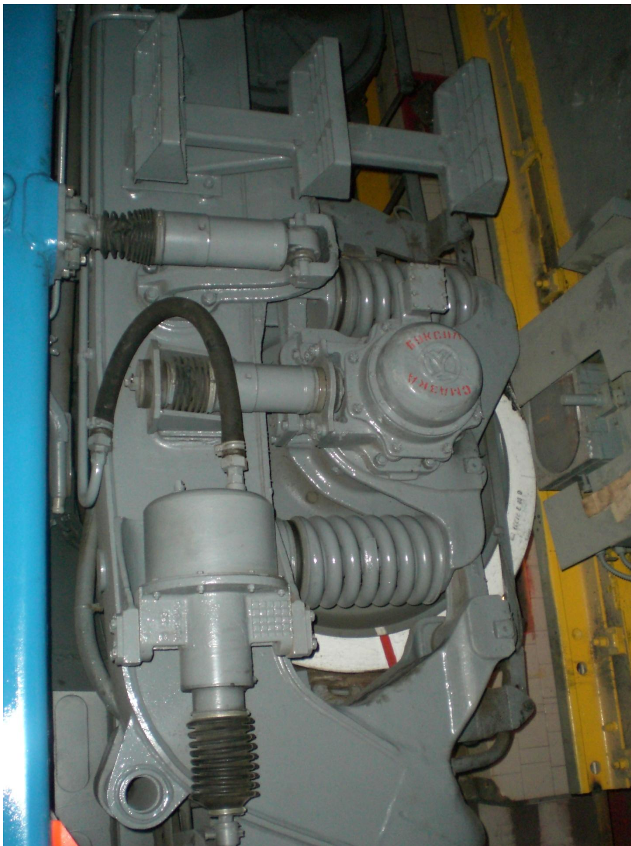
Рис. 24б - Колесная пара с рессорным подвешиванием
