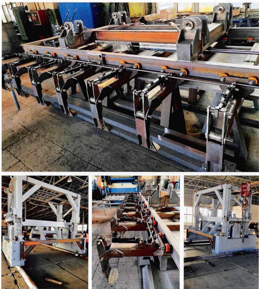
Мобильная линия сборки рельсошпальной решетки (из презентации В.В. Шамраева)
