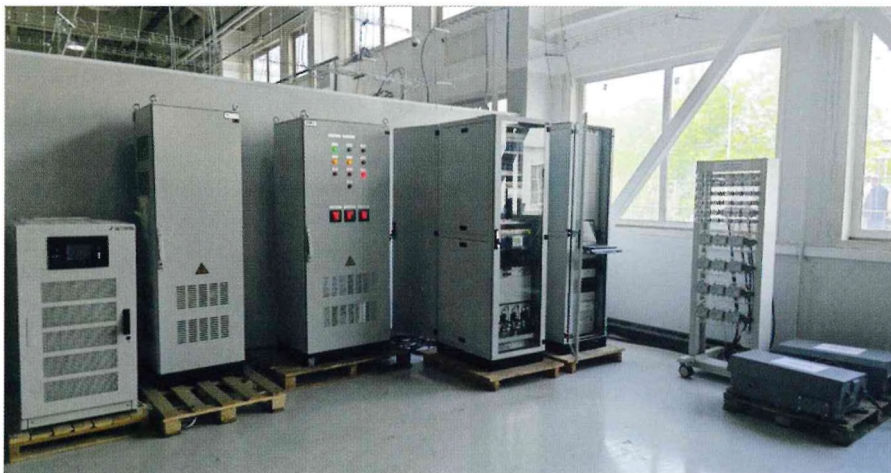
Аппаратно-программный комплекс управления пологой стрелкой АПК УПС
