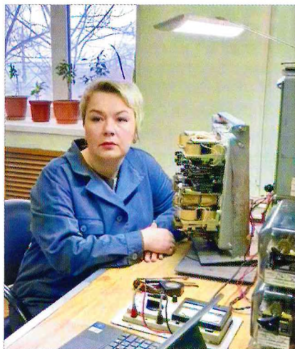
И.А. Каратаева производит регулировку контактной системы блока электрической централизации
