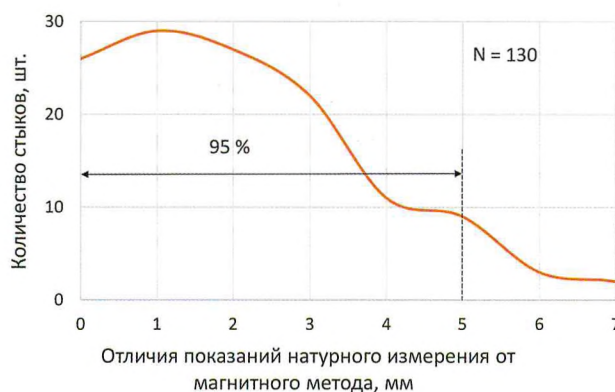
Рис. 6. Сравнение натуральных измерений стыковых зазоров с данными магнитного метода
