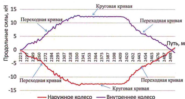
Рис. 1. Продольные силы, возникающие при проследовании кривой грузовым составом
