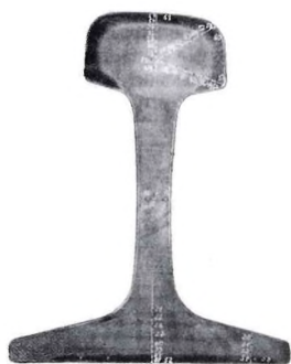
Рис. 2. Макроструктура на поперечном темплете рельса типа Р65 после закалки быстродвижущимся потоком воды. Конфигурация упрочненного слоя рельса охватывает всю поверхность головки и аналогично на подошве, без выхода на перо
