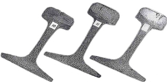
Рис. 9. Три характерных усталостных излома рельсовых проб после непрерывно-последовательной заковки быстродвижущимся потоком воды с температуры 1000 °С и последующего отпуска
