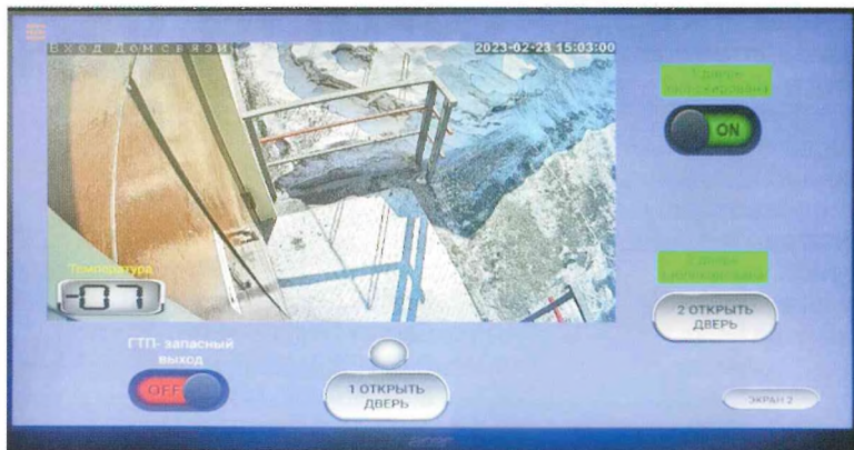
Информационное табло системы видеонаблюдения и управления доступом в дом связи станции Тынды
