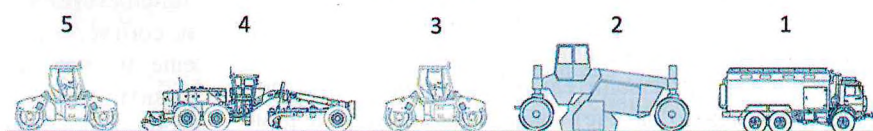
Рис. 2. Технологический процесс устройства ПЗС с использованием машин: 1 — распределение вяжущих; 2 — ресайклинг; 3 — уплотнение кулачковым катком; 4 — планировка поверхности ПЗС; 5 — уплотнение гладковальцовым катком
