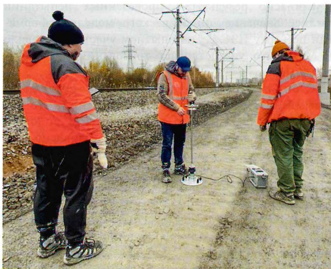
Рис. 3. Определение динамического модуля деформации грунта
