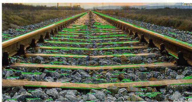
Рис. 6. Выделение по характерным признакам границ железнодорожного пути средствами технического зрения методом Хафа
