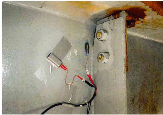
Рис. 3. Места наклеивания тензодатчиков по концам приварки ребер жесткости
