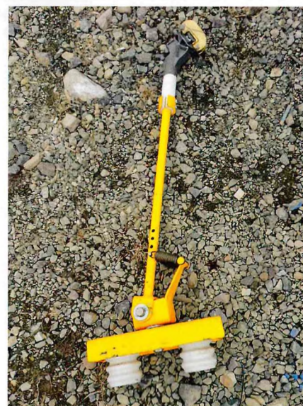
Рис. 3. Токосприемник штангового типа крана КРБ-10
