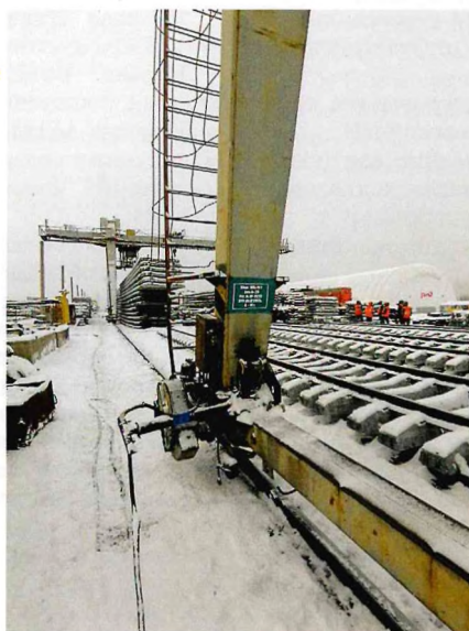
Рис. 2. Питание крана гибким шланговым кабелем
