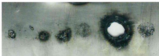
Рис. 1. Отпечатки анодных пятен на стороне наплавки в диапазоне 80–160 А при диаметре полюсного наконечника 16 мм
