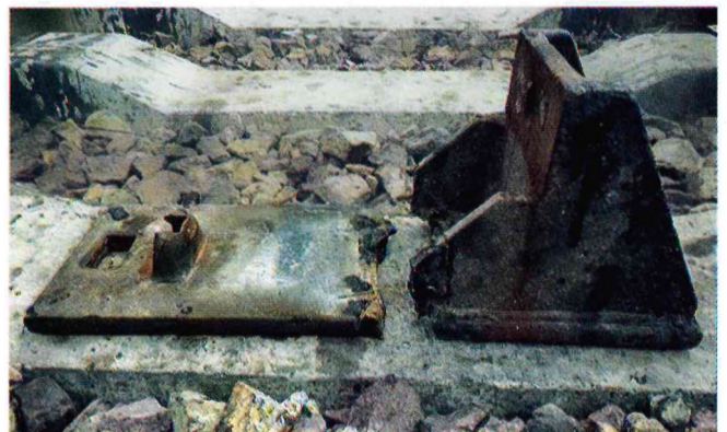
Рис. 3. Характерный вид разрушения контррельсовой подкладки
