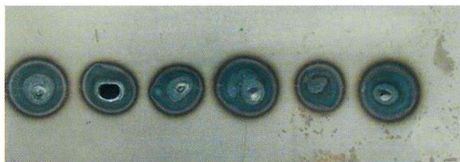
Рис. 2. Отпечатки наплавки в диапазоне 40–100 А при диаметре полюсного наконечника 19 мм
