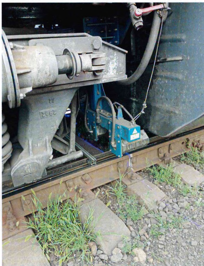
Рис. 2. Фрагмент системы ИИС КСИ, размещенной на маневровом локомотиве
