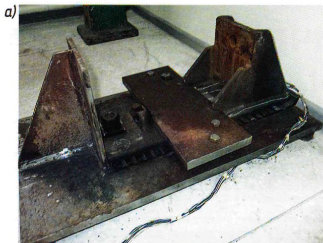
Рис. 5. Дискретная модель подкладки с указанием мест размещения датчиков
