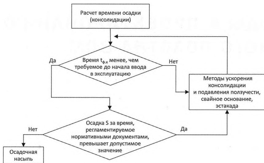
Рис. 2. Блок-схема для принятия решения о необходимости свайного основания
