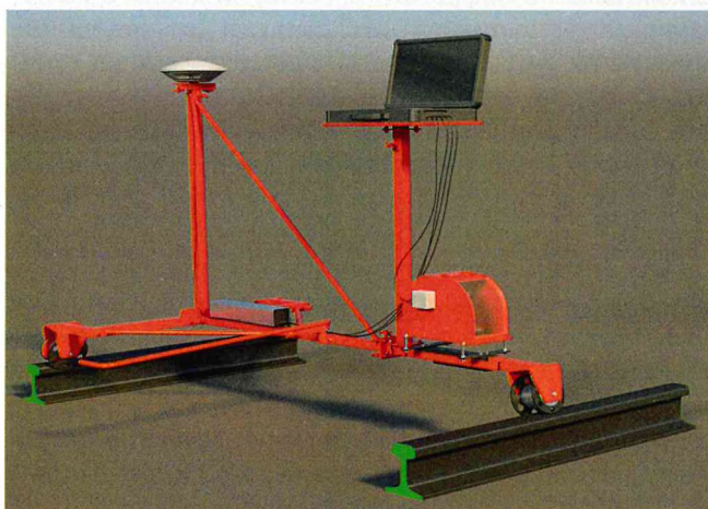
Рис. 3. Оборудование для испытаний сканирующей лазерной системы бокового нивелирования
