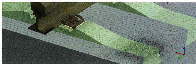
Рис. 2. Сетка элементов участка пути и сгущение в областях оценки напряженно-деформируемого состояния (ЖБР-Ш, 1840 шп/км)
