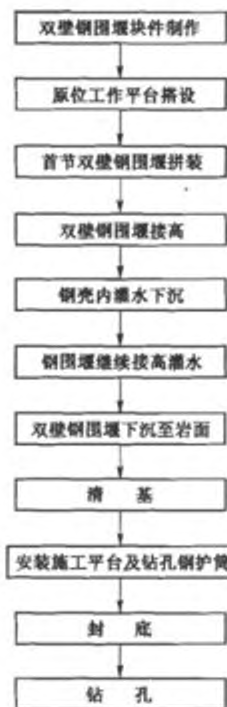
图 9.4.2—2 双壁钢围堰原位施工流程图
