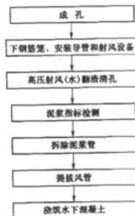
图 5.5.1 高压射风(水)辅助清孔施工流程图
