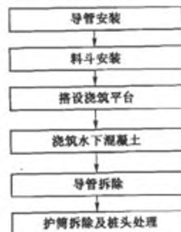
图 7.1.1 水下混凝土浇筑施工流程图
