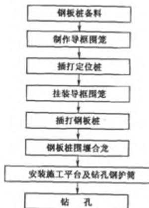
图 9.3.1 钢板桩围堰施工流程图
