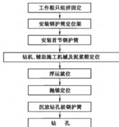
图 9.6.1 浮船工作平台施工流程图
