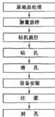
图 8.4.1 溶洞预注浆施工流程图
