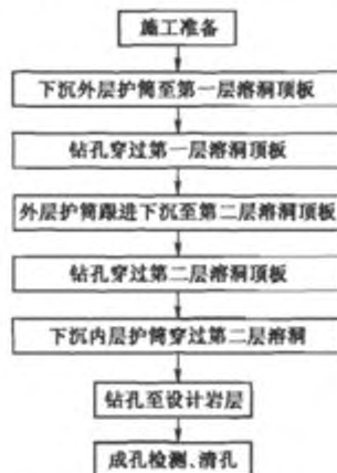
图 8.3.1 双层护筒跟进法施工流程图
