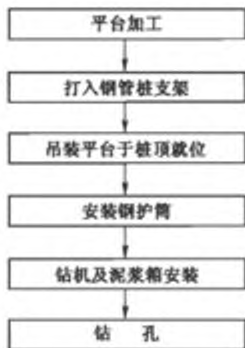
图 9.5.1 钢管桩支架平台施工流程图
