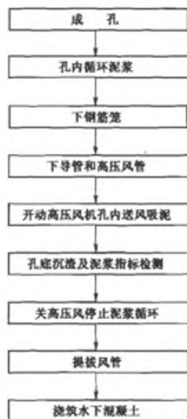
图 5.2.1—2 空气吸泥机清孔施工流程图
