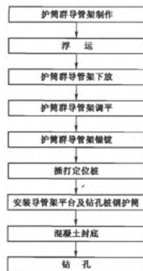
图 9.7.1 导管架平台施工流程图
