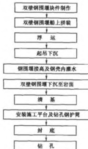
图 9.4.2—1 双壁钢围堰浮运施工流程图
