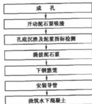
图 5.2.1—1 泥石泵吸泥清孔施工流程图
