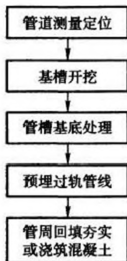
图 13.5.2—2 预埋过轨管线 施工工艺流程图
