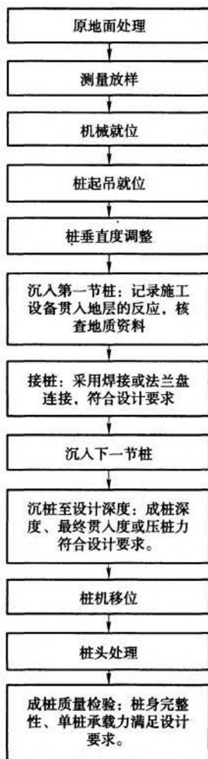
图 5.17.9 混凝土预制桩施工工艺流程图
