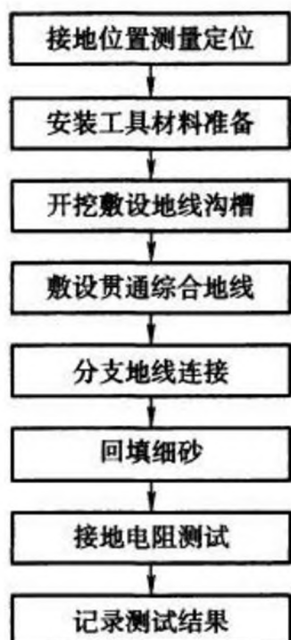
图 13.5.2—1 综合接地 施工工艺流程图
