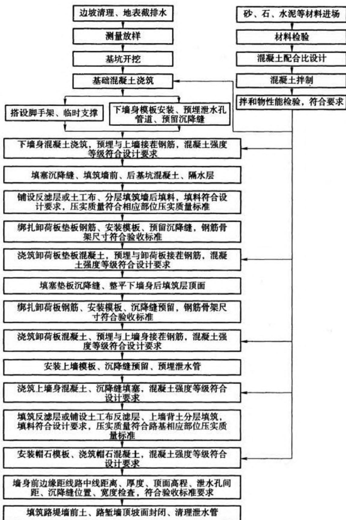
图 10.3.7 短卸荷板挡土墙施工工艺流程图
