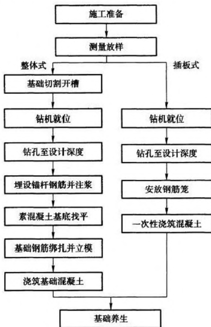
图 13.4.2 声屏障基础施工流程图
