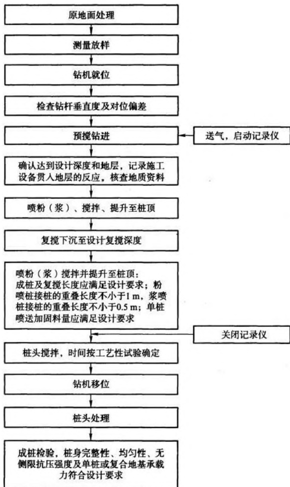
图 5.14.5 搅拌桩施工工艺流程图
