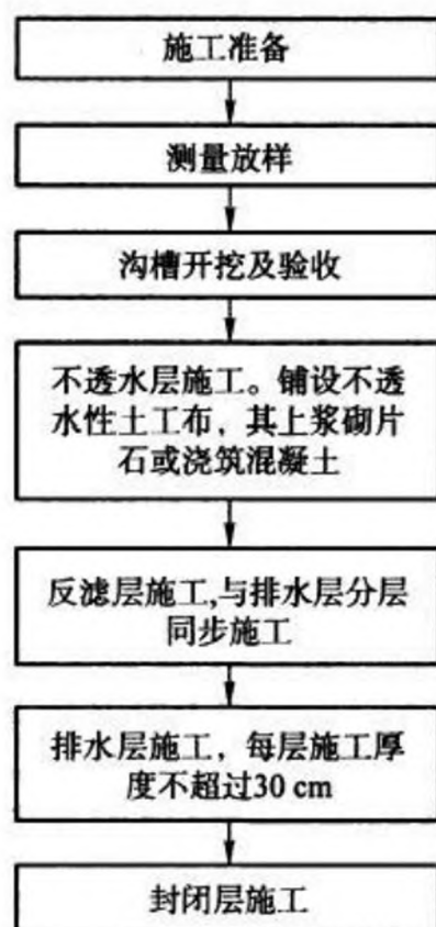
图 12.3.9 支撑渗沟施工工艺流程图
