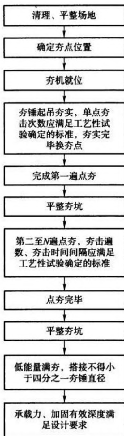
图 5.6.3 强夯施工工艺流程图
