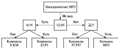
Рис. 40. Схема проверок элементов цепи катушки МР3 ведущей секции
