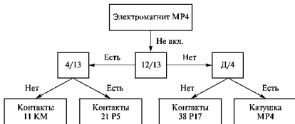
Рис. 41. Схема проверок элементов цепи катушки МР4 ведущей секции
