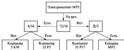
Рис. 39. Схема проверок элементов цепи катушки МР2 ведущей секции
