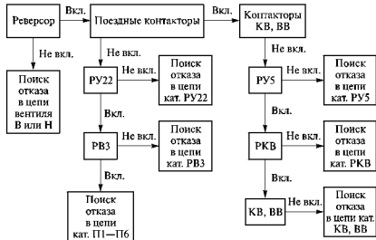
Рис. 76. Проверка работоспособности и поиск отказавших элементов в цепи трогания
