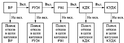
Рис. 85. Проверка работоспособности и поиск отказа в цепи пуска компрессора
