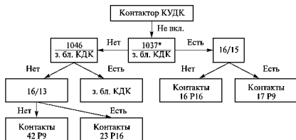
Рис. 43. Схема проверки элементов цепи катушки контактора КУДК после включения контактора КДК
