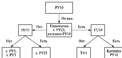
Рис. 71. Схема проверки цепи катушки РУ10
