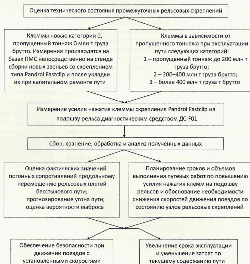
Рис. 2. Блок-схема оценки технического состояния промежуточных рельсовых скреплений
