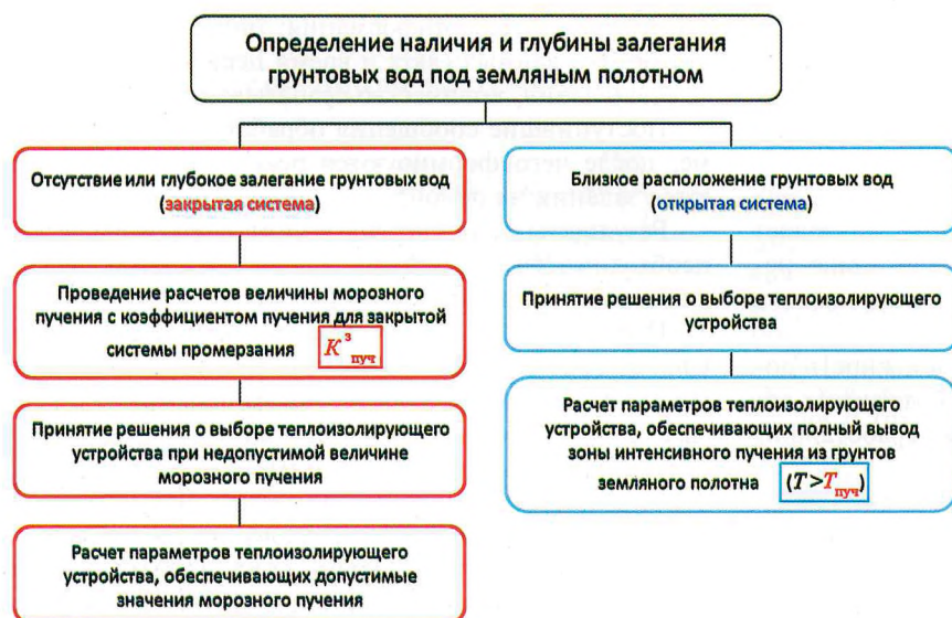
Рис. 1. Алгоритм метода определения параметров противопучинных конструкций
