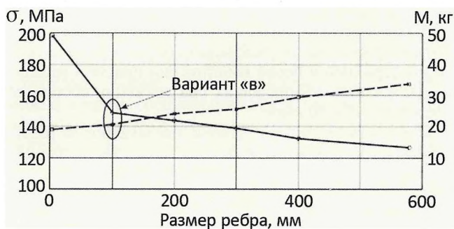
Рис. 9. Зависимость эквивалентных напряжений (сплошная линия) и массы подкладки M (штриховая) от протяженности свисающих ребер жесткости
