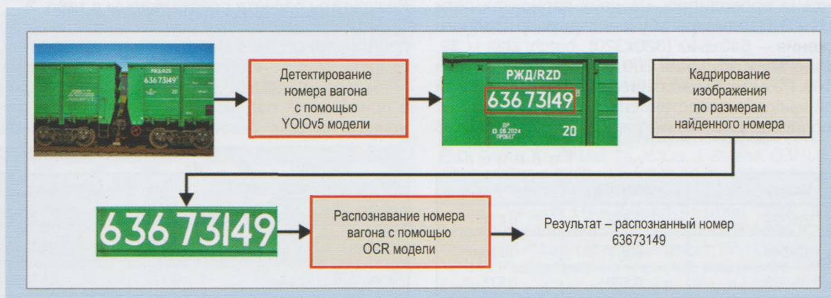
Схема алгоритма распознавания номера вагона
