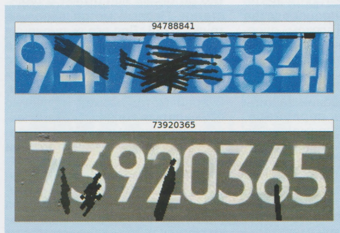
Пример номера вагона с реализованной аугментацией (загрязнения и подтеки)
