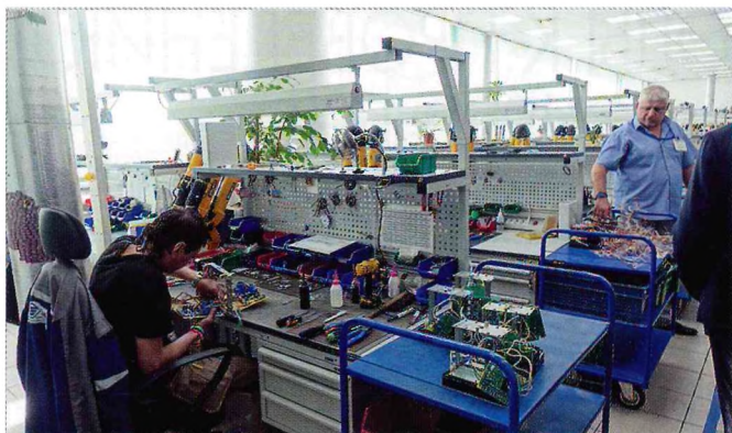
Участок изготовления микропроцессорных путевых генераторов
