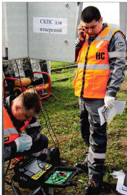
Электромеханики Р.В. Ишамбеков и С.А. Хапугин проводят измерения параметров кабельной линии связи
