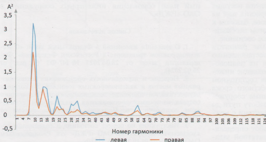
Рис. 2. Спектральное отображение вертикальных неровностей (для обеих рельсовых нитей) 151 км I пути Октябрьской дороги
