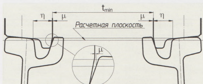
Рис. 3. Расчетная схема для определения максимальной расчетной ширины колеи в прямом участке пути для рельса РТ62
