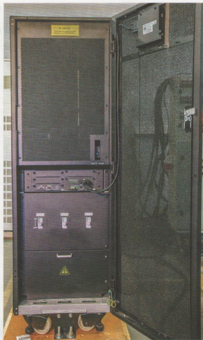
ИБП серии FR-UK 33 и MR 33 во время тестирования перед отправкой заказчику
