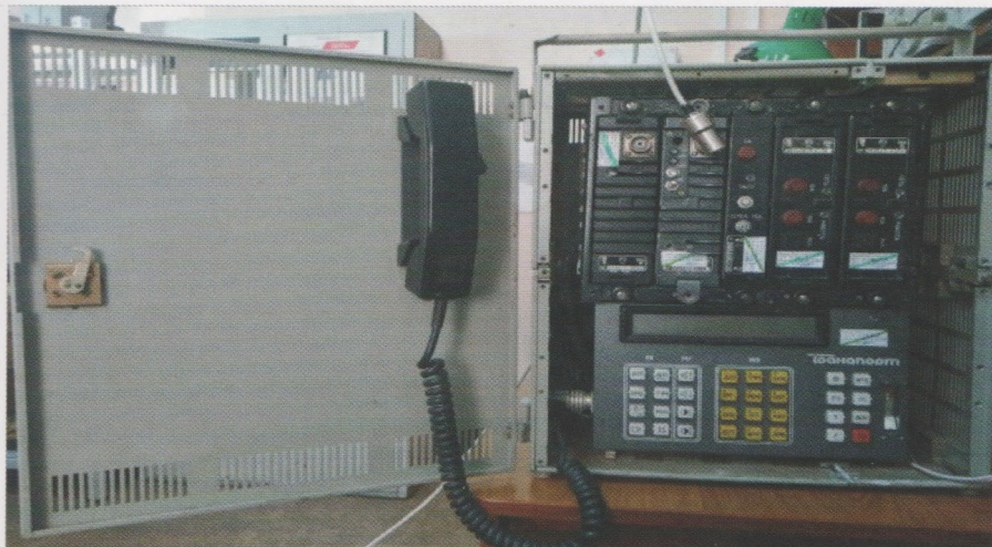
Передвижной комплекс для имитации работы локомотивной радиостанции
