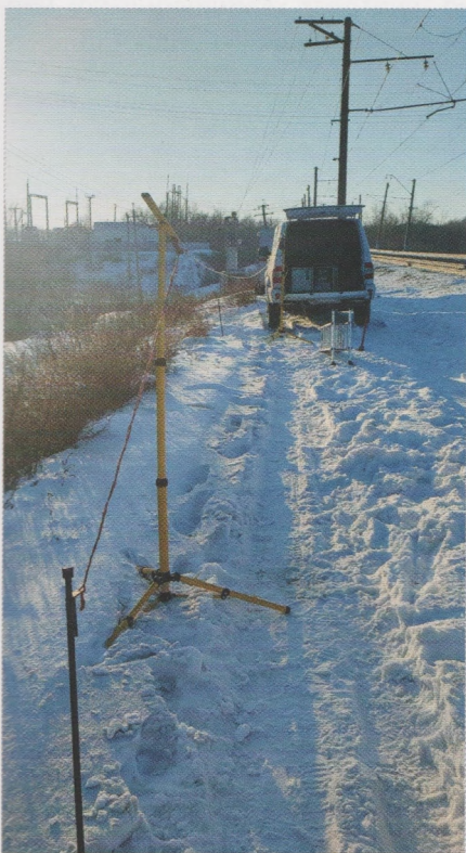
Использование медного троса в качестве антенны при проверке радиостанций
