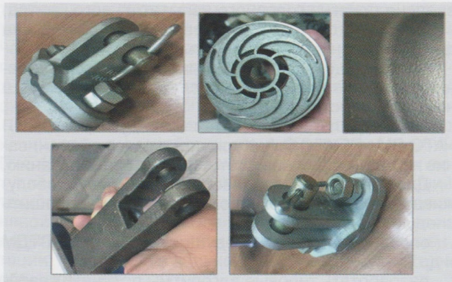
Примеры деталей и качество получаемых поверхностей, изготавливаемых методом ЛГМ
