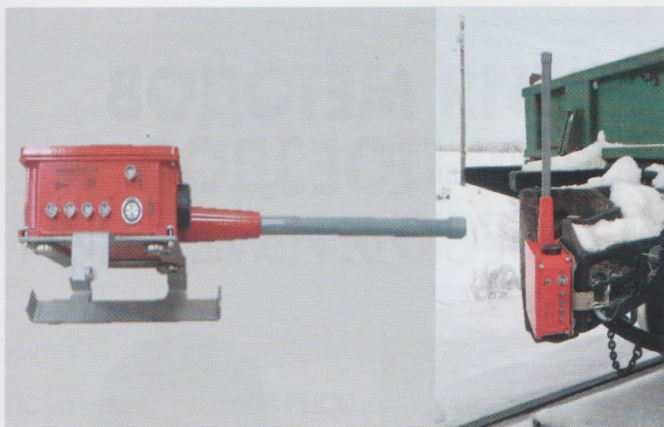
Хвостовой модуль и его установка на автосцепку вагона
