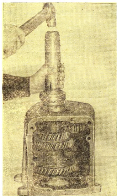
Рис. 46. Запрессовка шарикового подшипника промежуточного вала
