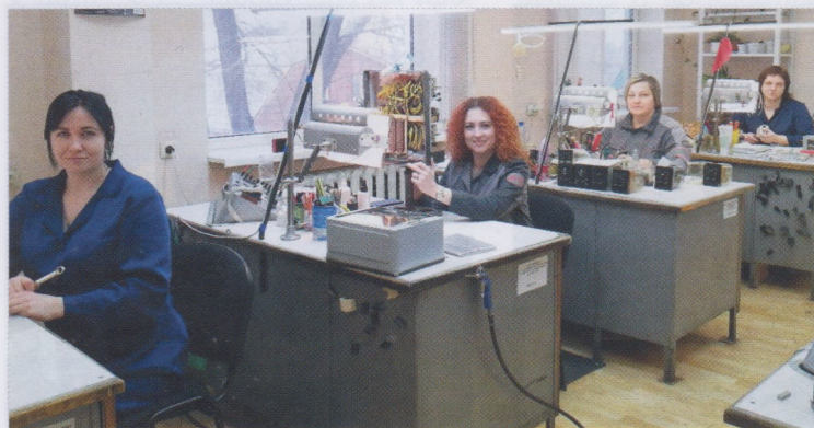
Электромонтер Е.А. Береглезова и электромеханики Е.Н. Мешкова, В.С. Кривченко, О.С. Фролова производят ремонт релейной аппаратуры
