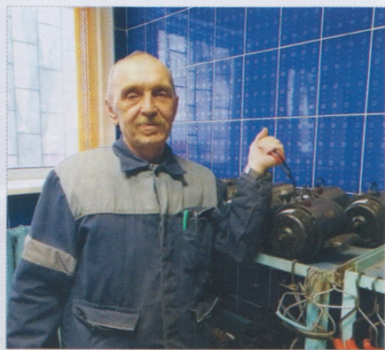
Электромонтер В.В. Моткин производит ремонт электродвигателей
