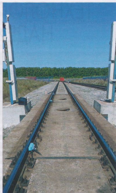
Датчик еДКТ на вагонных весах, ООО «Кроношпан Башкортостан»
