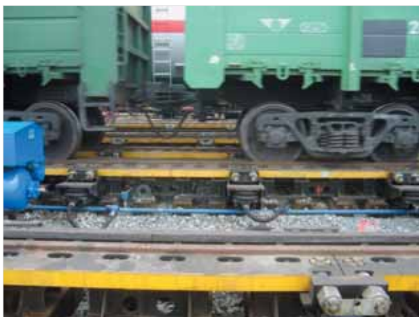
Вагонный замедлитель типа КЗПУ
