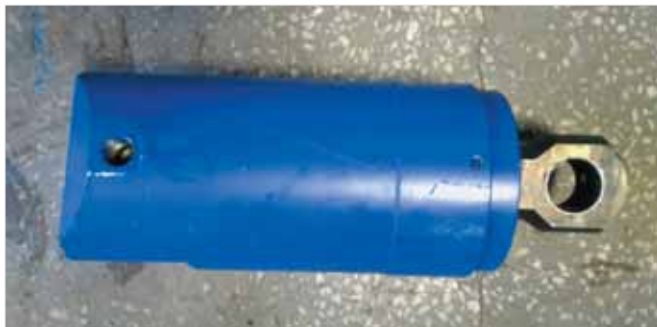
Необслуживаемый усовершенствованный демпферный узел
