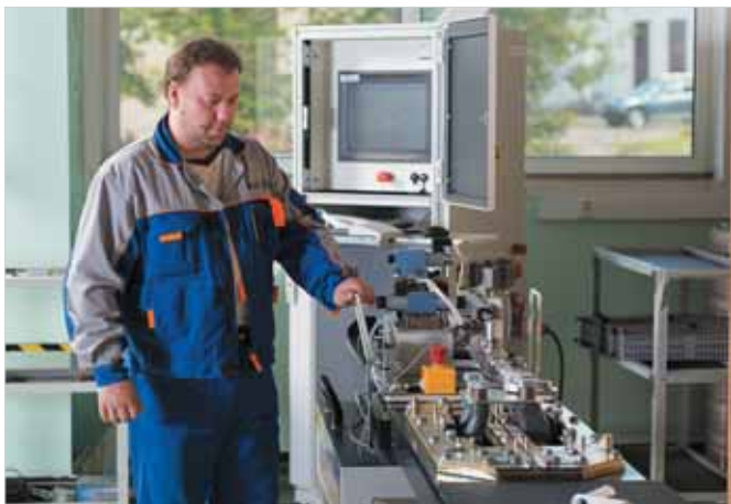
Тестирование стрелочного электропривода EBISwitch 2000 на испытательном участке ОАО «ЭЛТЕЗА»
