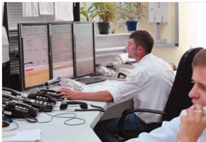
Автоматизированное рабочее место дежурного по станции системы МПЦ EBILock 950
