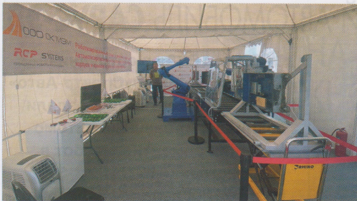
Поточная автоматизированная линия ремонта корпуса и крыши стрелочного электропривода
