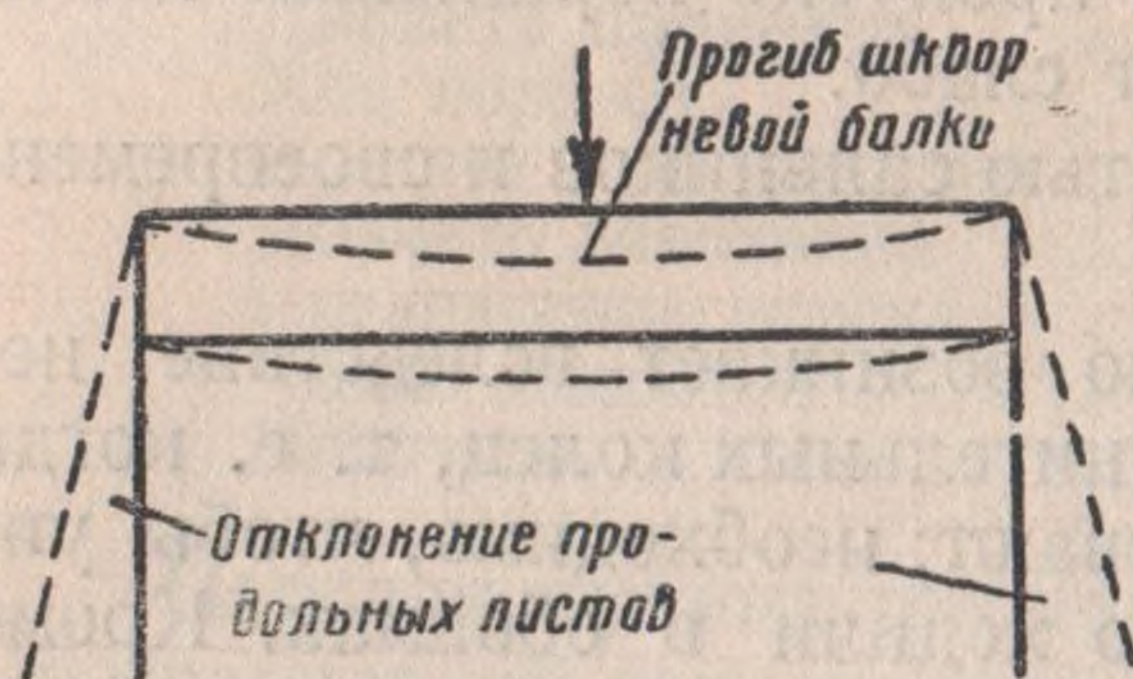
Фиг. 5. Что происходит при работе крана без опор
