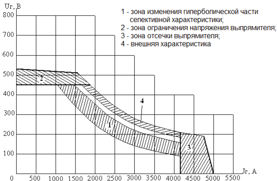
Рисунок 58 - Внешняя и селективная характеристика одной силовой установки
