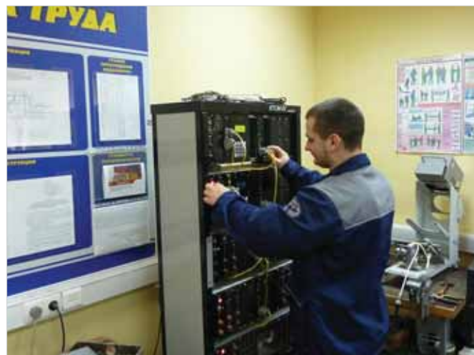
Электроник ШТЦ С.С. Кирюхин проверяет оборудование на стенде КТСМ-02
