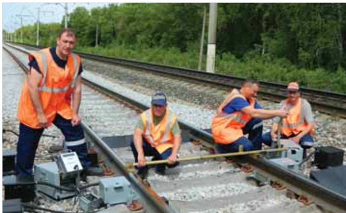
Электромеханики (слева направо) А.В. Постельга, А.А. Чулков, С.А. Ерёмченко, А.А. Денисов занимаются калибровкой и ориентировкой аппаратуры КТСМ
