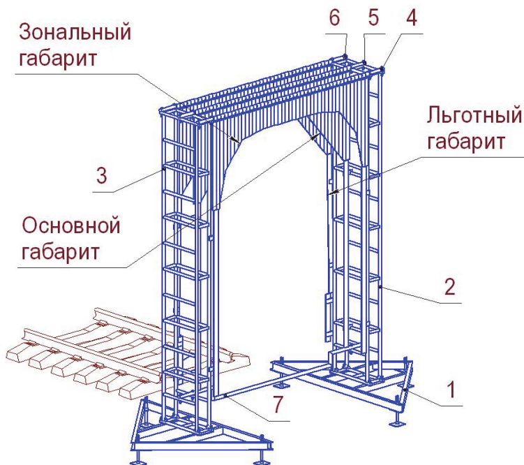
1 – рама; 2, 3, 4, 5, 6 – элементы металлоконструкции макета; 7 – балка монтажная
