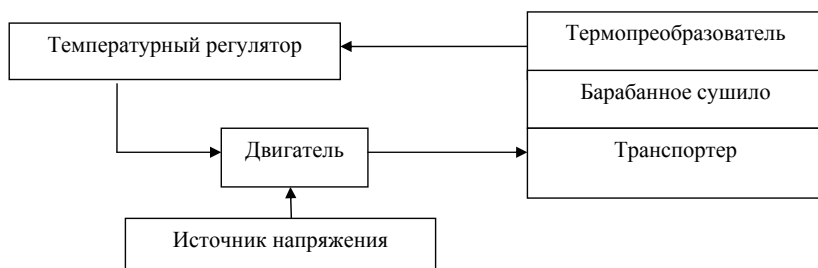
Структурная схема аппаратуры контроля за температурой сушки песка
