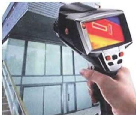
Термографическое обследование зданий с помощью тепловизора Testo 882
