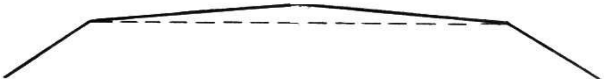
Рисунок 1.38 – Трикутна форма основної площадки земляного полотна
