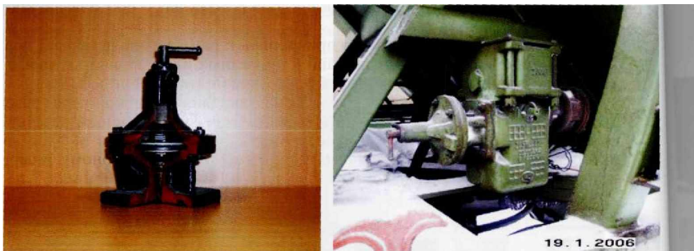
Рис. 10.4. Магистральная часть воздухораспределителя
