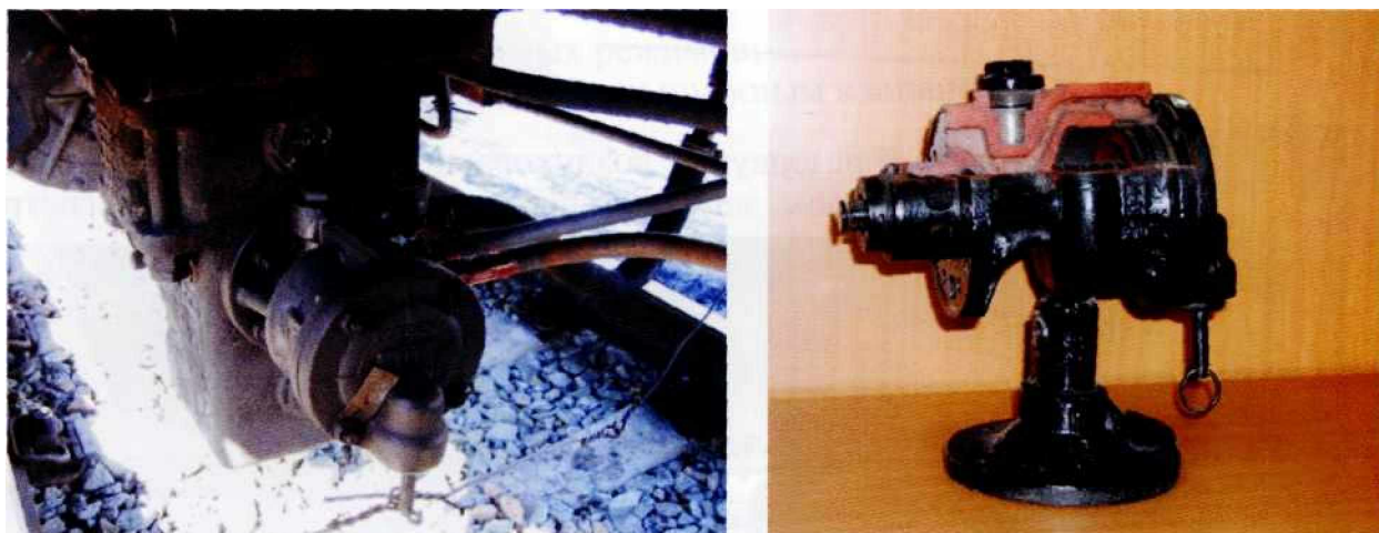
Рис. 10.5. Главная часть воздухораспределителя
