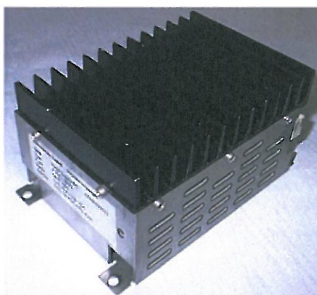
Рисунок 5.20 - Источник питания вентиля-формирователей биполярных транзисторов
