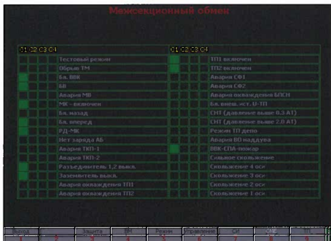
Рисунок 22.19 – Информационное окно «Межсекционный обмен». Режим «Состояние МСУЛ»
