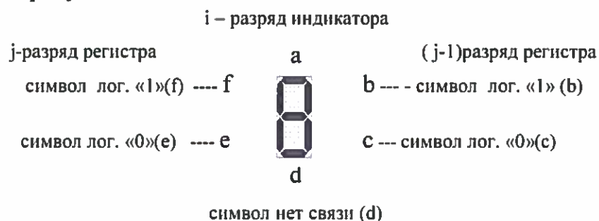
Рисунок 21.7 - Индикация логических значений при чтении содержимого регистра контроллера
