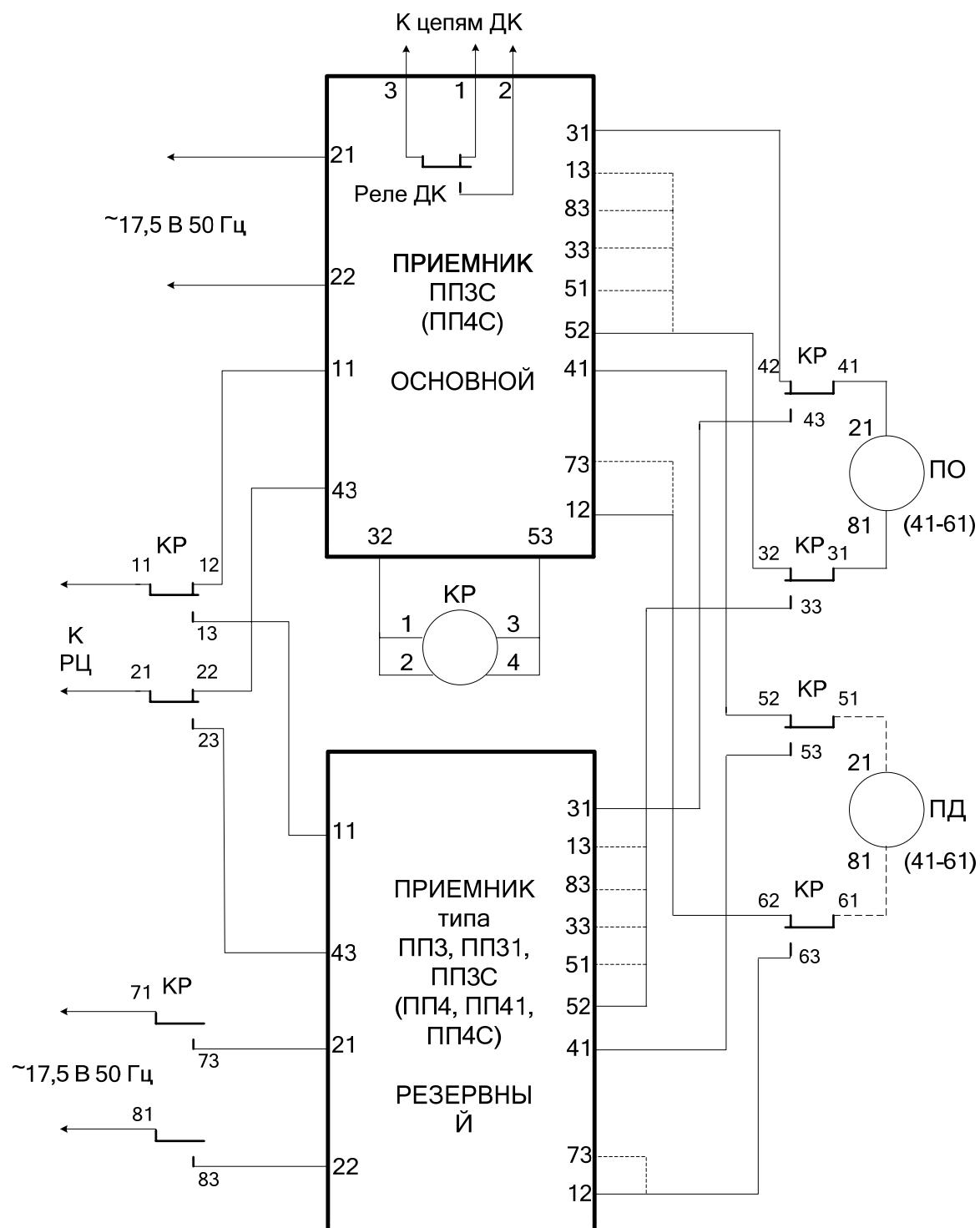
Рис.4 - Схема включения приемников ПП3С (ПП4С) с резервированием приемниками типа ПП3, ПП31, ПП3С (ПП4, ПП41, ПП4С)
