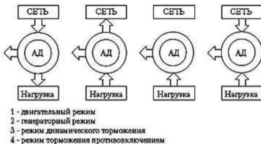
Рисунок 3.3 – Направления преобразования энергии в тормозных режимах
