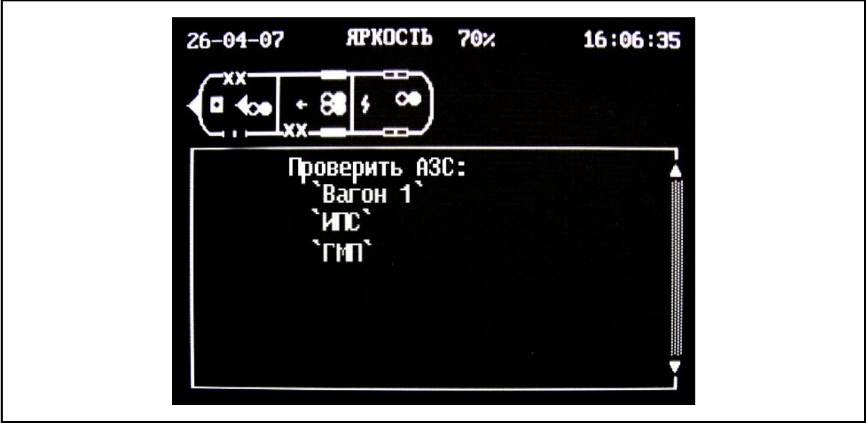
Рисунок 4.68 – Пример диагностического сообщения проверки АЗС
