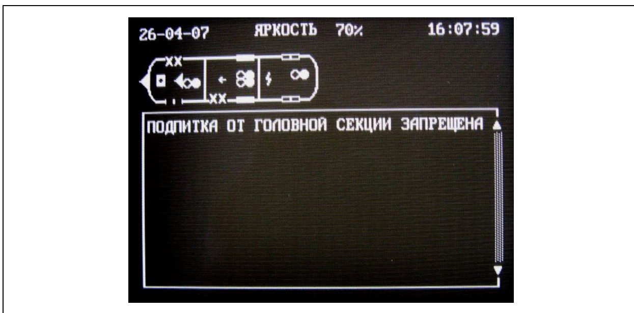
Рисунок 4.47 – Запрет включения режима підплатки от головного вагона
