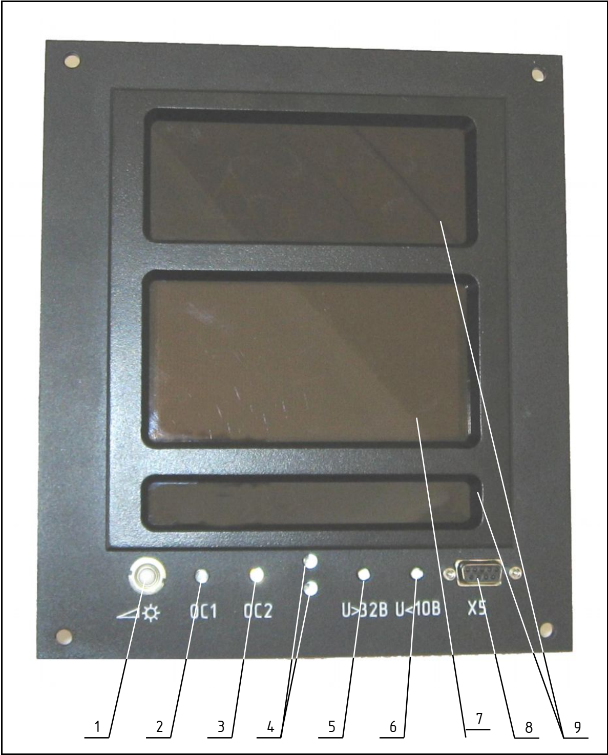
Рисунок 3.3 – Приборная панель транспортного средства 750.05-01М1. Вид спереди
