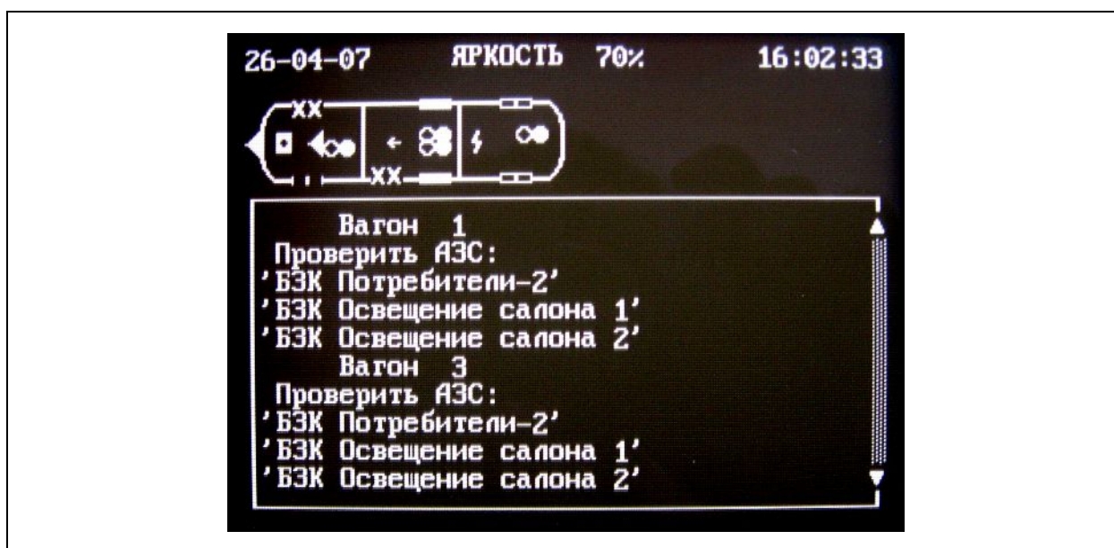
Рисунок 4.34 – Пример сообщения о невозможности включения освещения салона
