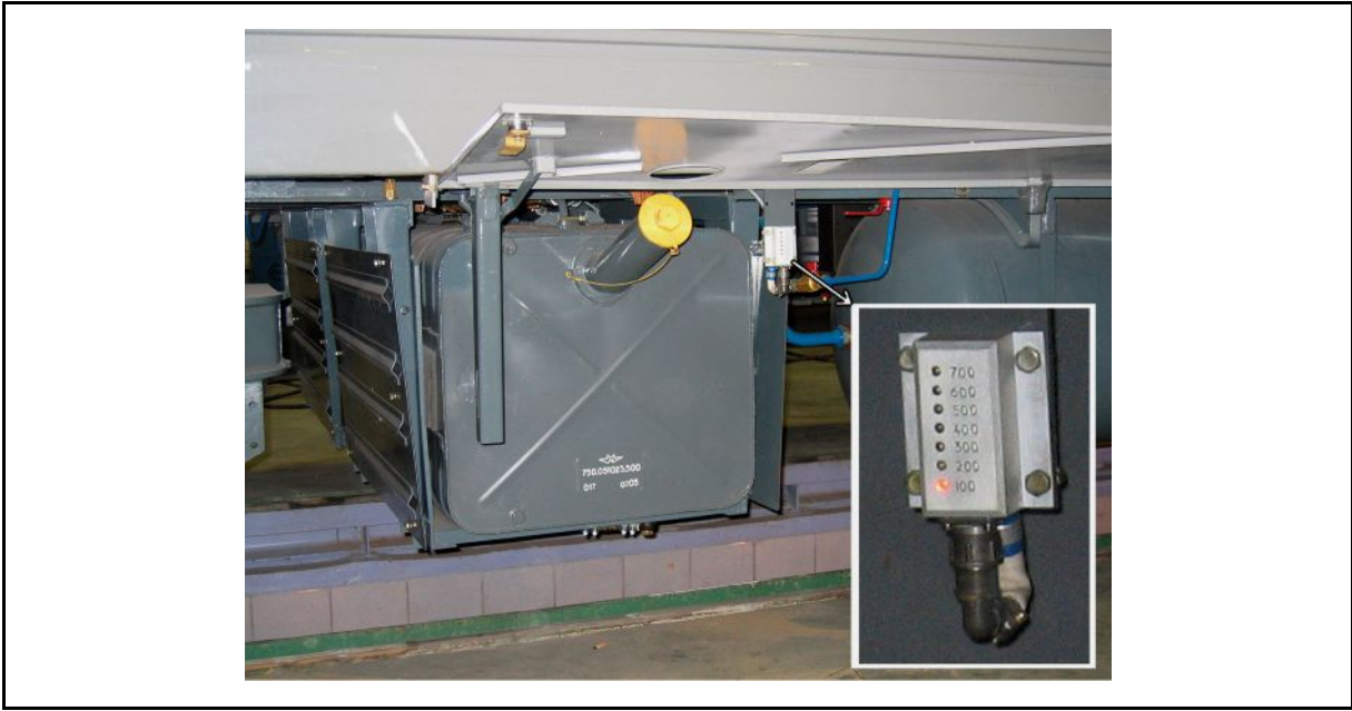
Рисунок 3.25 – Размещение указателя (индикатора) уровня топлива
