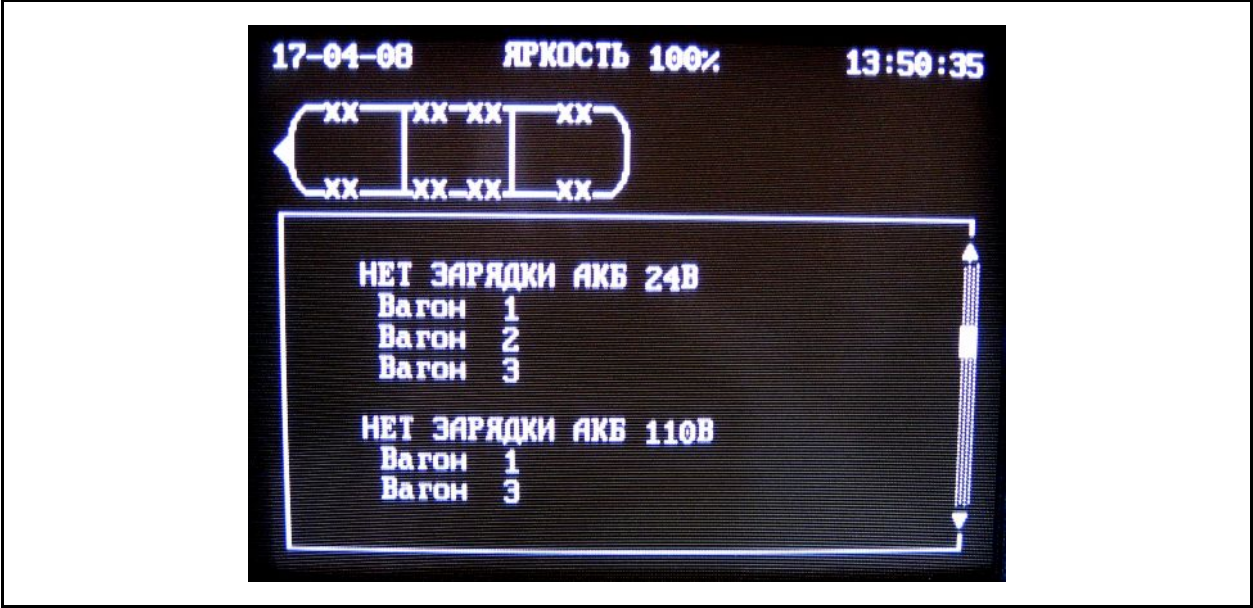
Рисунок 4.96 - Отсутствие зарядки АКБ
