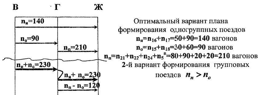
Рис. 5.2 2-й вариант формирования групповых поездов, n_n > n_o
